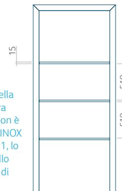
Il pannello è disponibile nella versione con la scanalatura più sottile (6 mm), in cui non è possibile inserire l'insero INOX - modello del pannello 111, lo stesso modello nel pannello Wood ha una scanalatura di 4 mm.
