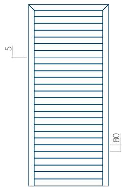
La dimensione della scanalatura nei pannelli Wood è di 4 mm.
