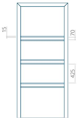
Il pannello è disponibile nella versione con la scanalatura più sottile (6 mm), in cui non è possibile inserire l'inserto INOX - modello del pannello 112, lo stesso modello nel pannello Wood ha una scanalatura di 4 mm.
