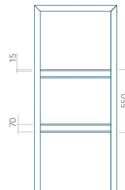
Il pannello è disponibile nella versione con la scanalatura più sottile (6 mm), in cui non è possibile inserire l'inserto INOX - modello del pannello 110, lo stesso modello nel pannello Wood ha una scanalatura di 4 mm.
