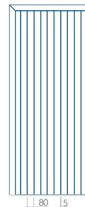
La dimensione della scanalatura nei pannelli Wood è di 4 mm.
