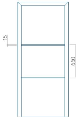
Il pannello è disponibile nella versione con la scanalatura più sottile (6 mm), in cui non è possibile inserire l'insero INOX - modello del pannello 109, lo stesso modello nel pannello Wood ha una scanalatura di 4 mm.
